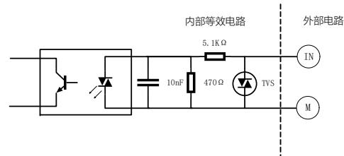
上图中 M 为外部输入信号的公共端, IN 为外部输入信号。
