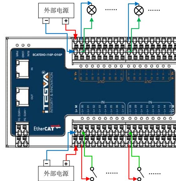
注意: 输出信号的最大驱动电流为 500mA, 使用前请查看外部负载额定功率、内阻
